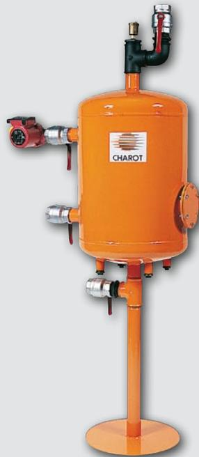
Conçu pour des installations de chauffage jusqu'à 2000 kW et un débit de traitement jusqu'à 7 m<sup>3</sup>/h, le **MAGNETIS** élimine en permanence les boues contenues dans le réseau de chauffage ceci grâce à 4 puissantes barres magnétiques spécifiques, disposées à l'intérieur de l'appareil.
