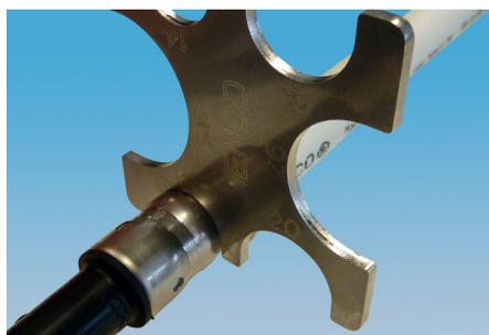
5. Pivotez l'instrument de mesure de 360° autour de l'impression sur le manchon à sertir et veillez à ce qu'ils se raccordent tous deux parfaitement comme indiqué à l'étape 4. En cas d'échec (par exemple, distance trop grande, entrave, etc.), cela signifie que le sertissage du raccord s'est mal déroulé. Si c'est le cas, nous vous recommandons de réaliser un assemblage par sertissage totalement neuf et de contrôler la machine à sertir ainsi que la mâchoire à sertir.
