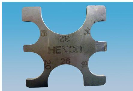
2. Recherchez le  $\varnothing$  correspondant sur l'instrument de mesure.
