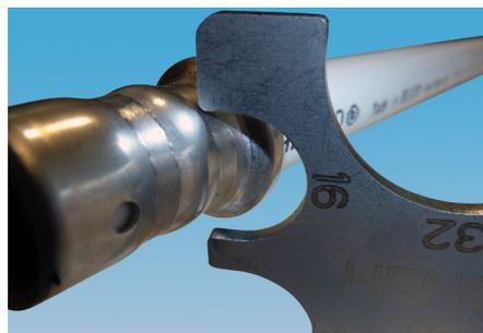
3. Placez l'entaille correspondante de l'instrument de mesure sur l'impression se trouvant sur le manchon à sertir.
