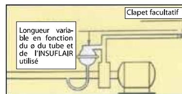
Ne pas oublier qu'un clapet "éventuel" sur le refoulement ne remplace pas le clapet d'aspiration (clapet crépine ou autre) qui lui, est obligatoire dans tous les cas où le niveau de l'eau pompée est plus bas que le groupe.
