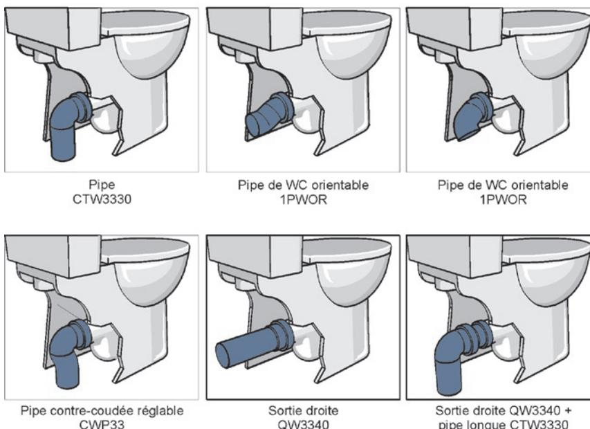
Les accessoires de raccordement sont à commander séparément en fonction de la configuration désirée.
