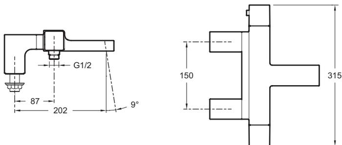
Description : Mitigeur thermostatique bain-douche sur gorge.. E9129. Collection : STRAYT. Poids : 3,5 kg. Normes et réglementations : Attestation de Conformité Sanitaire (ACS). Débit : 20 l/mn. Saillie du bec : 202 mm. Raccords : Avec raccords colonnettes. Mécanisme : Cartouche thermostatique à cire dilatable.. Entraxe : 150 mm.
