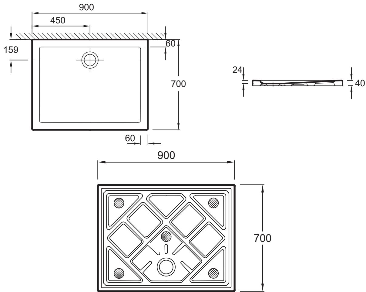
Descriptif CCTP : Receveur extra plat rectangulaire 90 cm. Collection : KYREO. DIMENSIONS : 90 x 70 x 4 cm. POIDS : 23,4 kg. MATERIAU : Céramique. TYPE D'INSTALLATION : Posé ou encastré. NORMES ET REGLEMENTATIONS : NF. FORME : Rectangulaire. DIAMETRE DE BONDE : 90 mm. MOTIF DE SURFACE : Lisse. NIVEAU D'ADHERENCE : PN6. LIVRE AVEC BONDE : Non.
