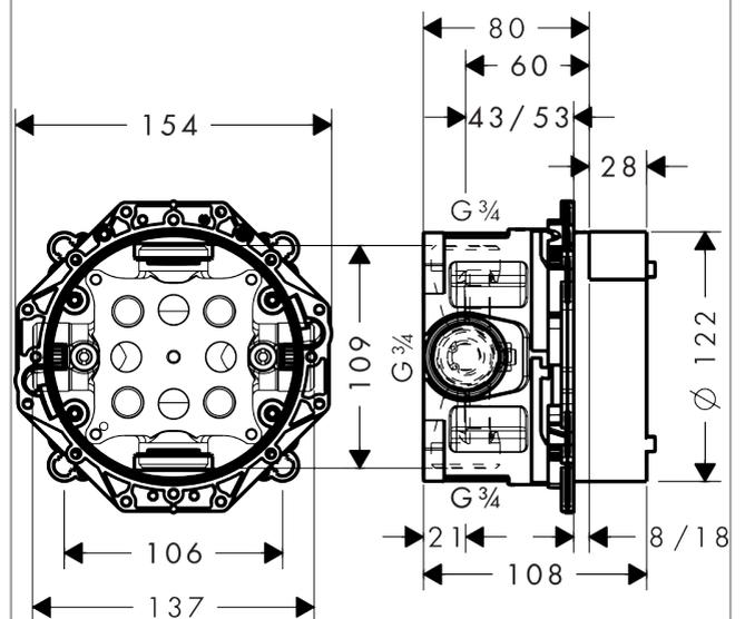
**Corps d'encastrement avec robinet d'arrêt**
