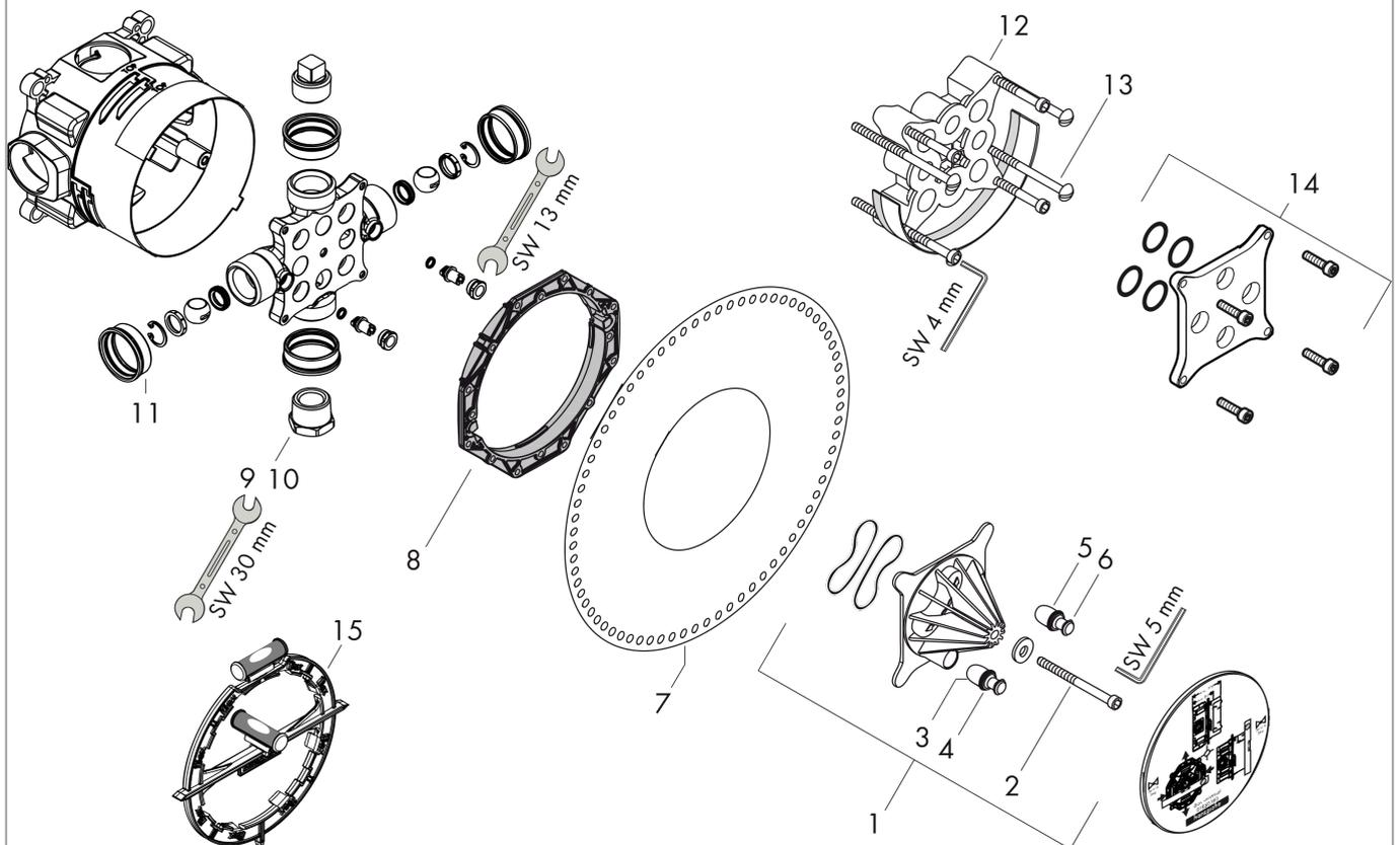
**Corps d'encastrement avec robinet d'arrêt**Surfaces: p.a. Numéro d'article: **01850180**
